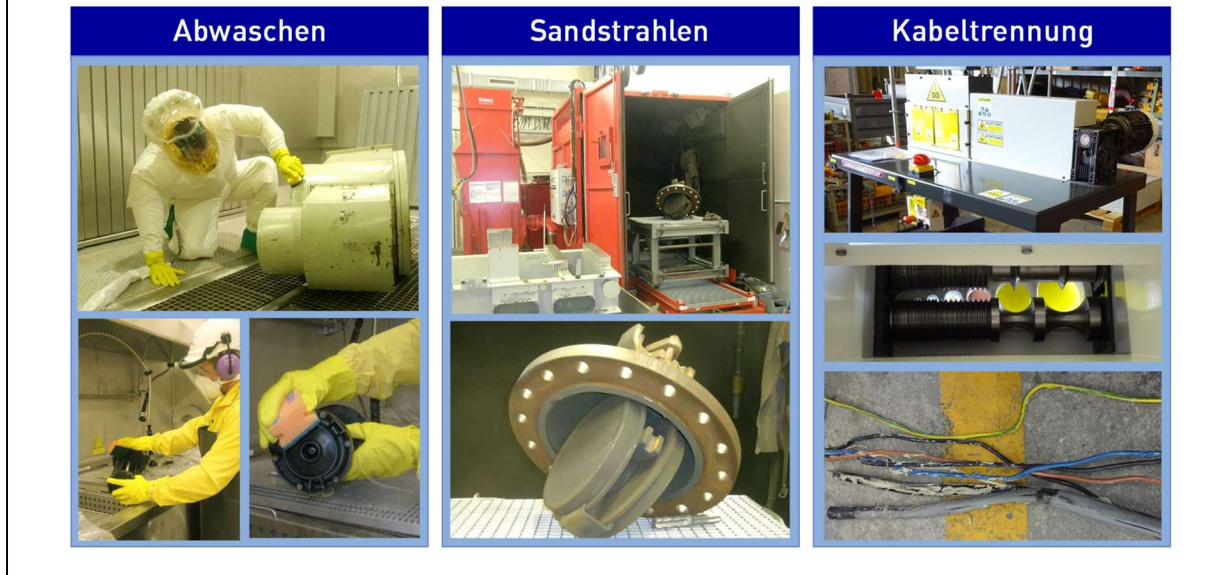
Abbildung 7: Beispiele für Verfahren zur Behandlung von Reststoffen
